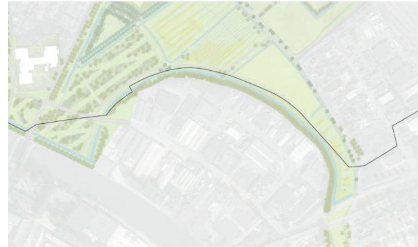
De oever van de oude Hunzeloop flauwer maken is soms beperkt mogelijk door de gasleiding die één meter gedekt moet blijven
