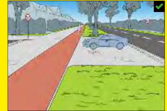
Opstelruimte tussen fietspad en hoofdrijbaan bij voorkeur 6,00 m breed (minimaal 5,00 m). Bij voorkeur voorrang regelen met inritconstructie.
