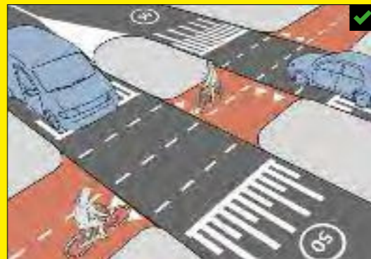
Fietsoversteek met middeneiland van minimaal 3,00 m breed en bij voorkeur verhoogd.
