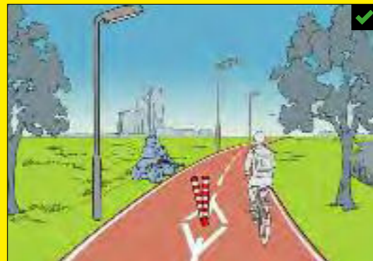
Fietspad bij voorkeur 4,00 m breed (minimaal 3,50 m) en bij voorkeur zonder paaltje. Een strook van minimaal 1,00 maaien.
